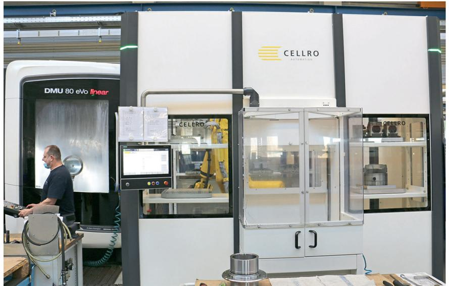
4 Cellro Ultimate und DMG DMU 80 eVo bilden zusammen ein flexibles Fertigungssystem, das hochproduktiv und autonom die Fertigungslose abarbeitet © Hanser
