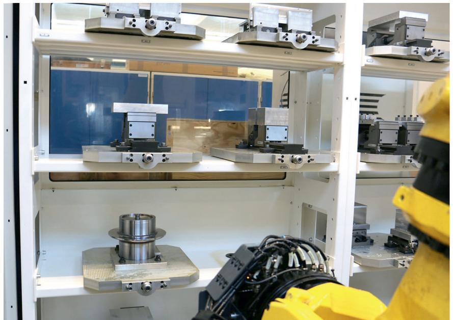
5 Auf den Regallagerplätzen werden vorgerüstete Paletten mit den Werkstücken eingelagert und zur Bearbeitung in den Maschinenraum eingebracht © Hanser
